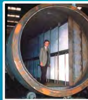
SLV TYPE - 130" # 150 LENGHT 21 m, 55 Ton
